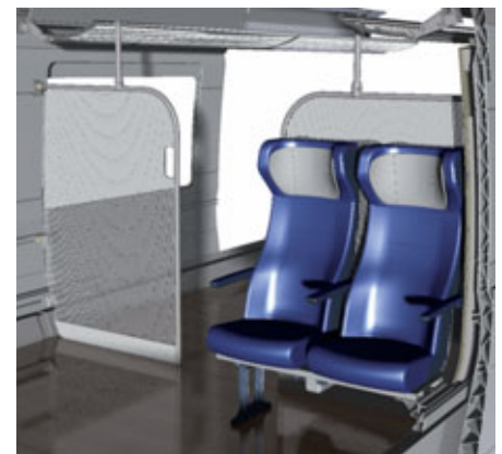
Im Innenbereich werden u. A. neue Glastrennwände eingebaut, die mit einer Abstützung das Gewicht auf den Gepäckablagen absichert.
