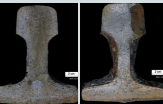
Bild rechts: Querbruchfläche mit halbelliptischem, stark korrodiertem Bruchausgang am seitlichen Schienenkopf; Schweißung 2
